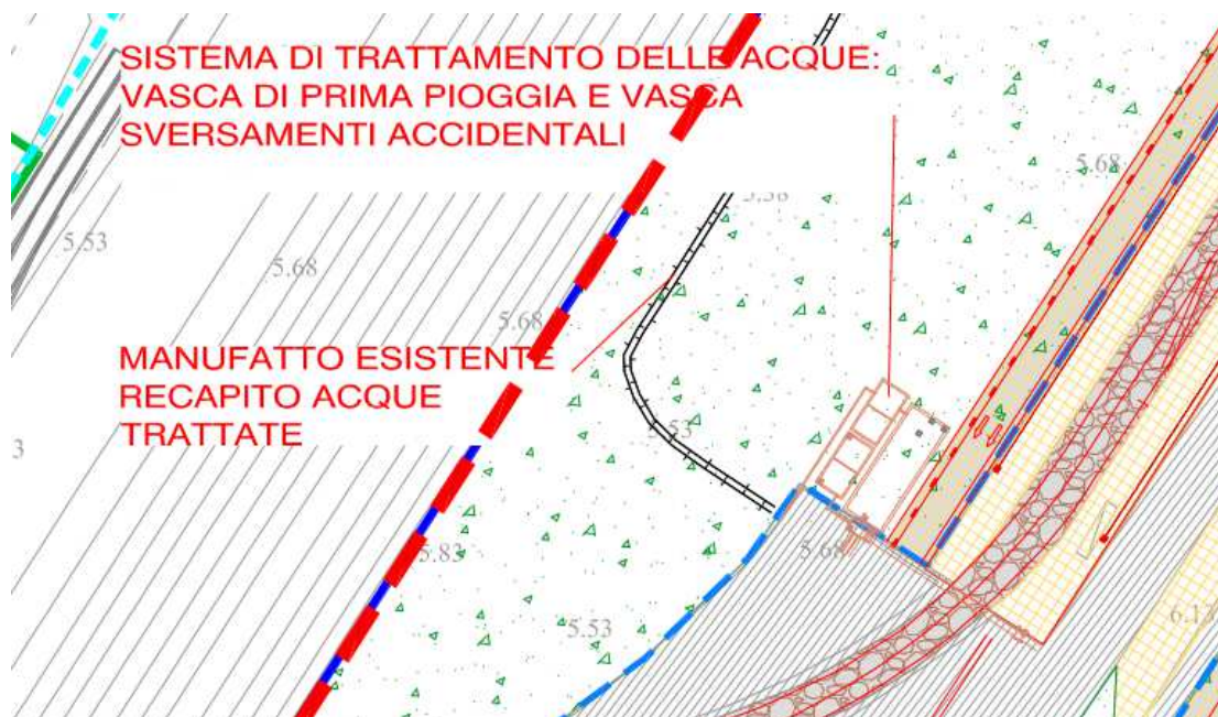
Vasca di prima pioggia, disoleatore e sversamenti accidentali - Stralcio progettuale presidio idraulico – Terminal Interporto
